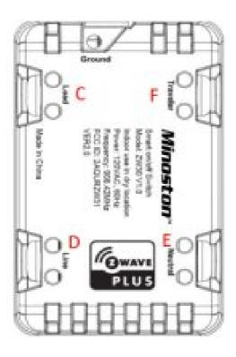
**MS12ZS Installation Wiring Diagram**
