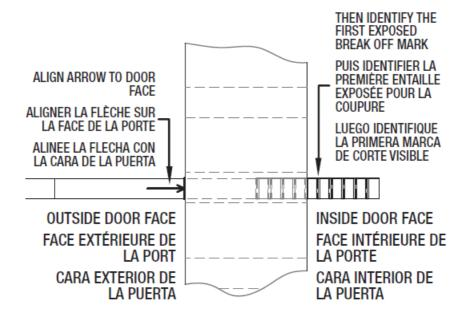
**BREAK OFF SPINDLE AT MARK**
