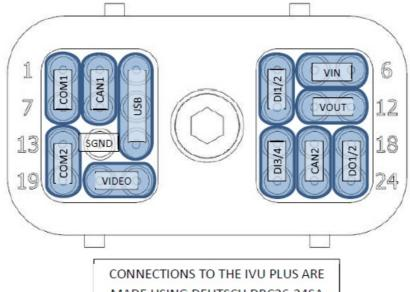
MADE USING DEUTSCH DRC26-24SA
