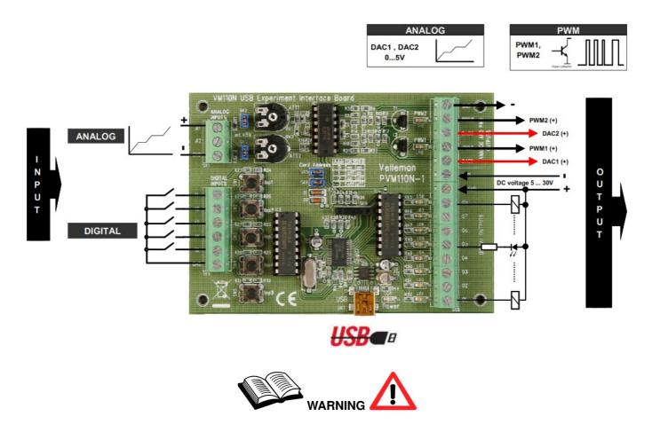
PLEASE NOTE THAT THE GROUND OF THE BOARD IS NOT ISOLATED FROM THE COMPUTER GROUND!
