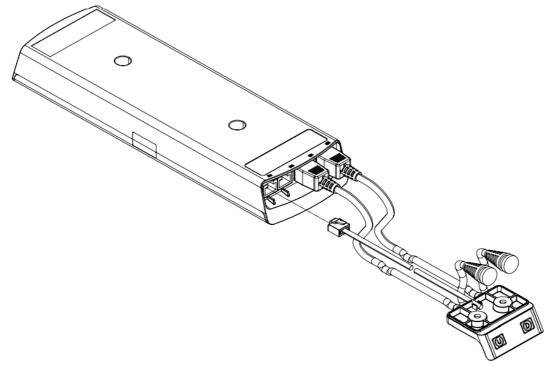
6. CONNECT THE SUPPLIED POWER CORD (AC) TO THE CONTROL BOX
