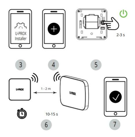
RANGE TEST FOR OPTIMAL INSTALLATION LOCATION
