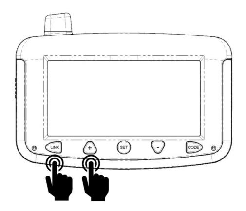
PRESS THE "LINK" AND "+" BUTTON SIMULTANEOUSLY THE CARAVAN / TRAILER ICON APPEARS ON THE SCREEN
