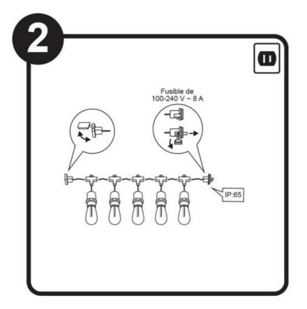
• 100-240 V  $\sim$  8 A fuse/Fusible 100-240 V  $\sim$  8
