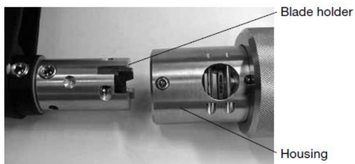
Fig. 4 Remove blade holder
