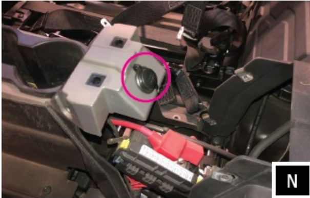
N. Disconnect the 12V socket.
