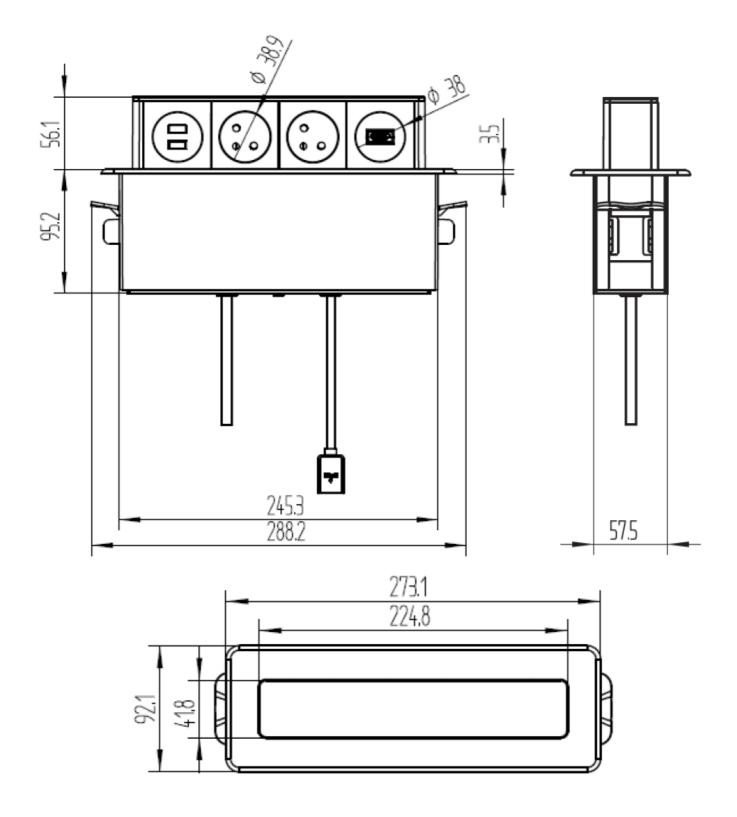
Vstup/Input: 250V~, max. 16A; max. 3680W Výstup/Output: 230V~, max. 16A; max. 3680W USB výstup: 5V DC / max. 2400mA, max. 12W
