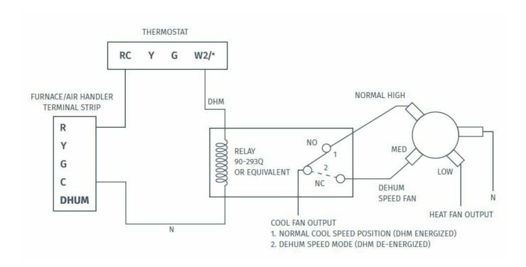
CONFIGURATION - SETTING HUMIDIFICATION/DEHUMIDIFICATION CONTROL CAPABILITY ON/OFF
