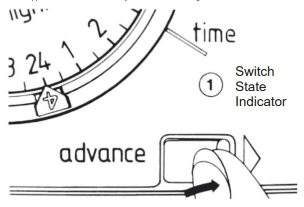
DO NOT OPERATE THE ADVANCE SWITCH WHEN A TAPPET IS AGAINST THE TIMELINE.
