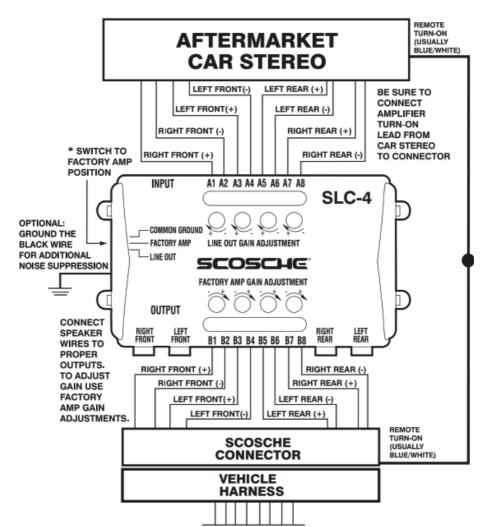
\* WITH SOME FORD PREMIUM SOUND OR DELCO BOSE COMMON GROUND SYSTEMS, IT MAY BE NECESSARY TO USE THE "COMMOND GROUND" OR "LINE OUT" SWITCH POSITION
