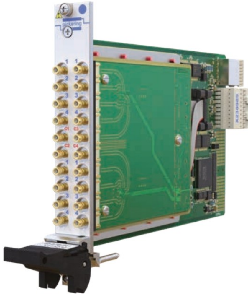
42-878-241 PXIe Quad 50 \Omega 4:1 RF Multiplexer
