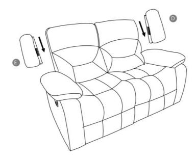
IF YOU WANT TO REMOVE THE BACKREST FROM THE BASE YOU HAVE TO OPEN THE METAL FLAT SPRING OF ONE SIDE AND PULL UP THE BACKREST . THEN DO THE SAME STEP ON THE OTHER SIDE.
