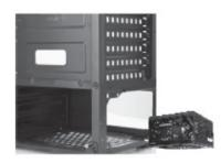
PUT THE POWER SUPPLY TO THE PSU LOCATION
