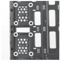
FIX 550 WITH SCREWS FROM BACK SIDE
