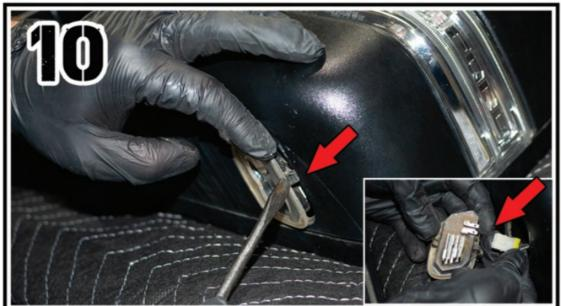
DEPRESS THIS TAB TO REMOVE THE PUDDLE LIGHT. DISCONNECT THE PUDDLE LIGHT.
