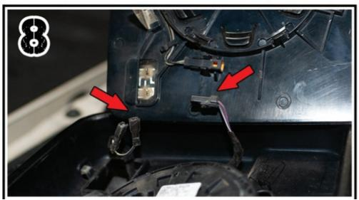
DISCONNECT THE HEATER PLUGS AND BLIND SPOT INDICATOR PLUG FROM THE MIRROR GLASS.
