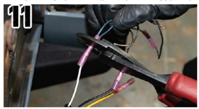
12. CONNECT THE TWISTED BROWN WIRES TO THE VEII OW WIRE ON THE QUICK DISCONNECT
