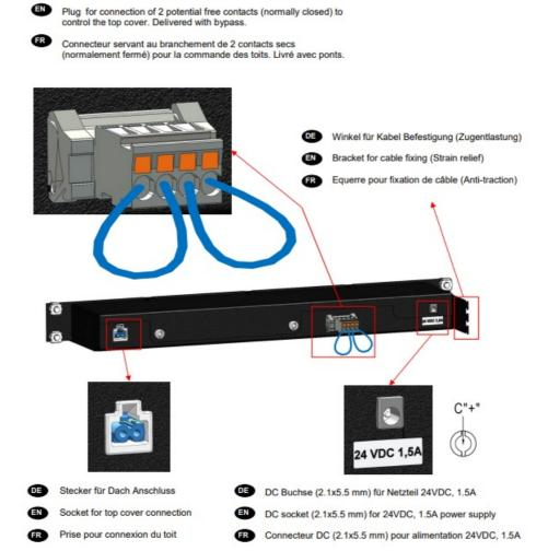
Stecker für den Anschluss von 2 potentialfreien Kontakten (Öffner) zur Steuerung der Dächer. Geliefert mit Brücken.
