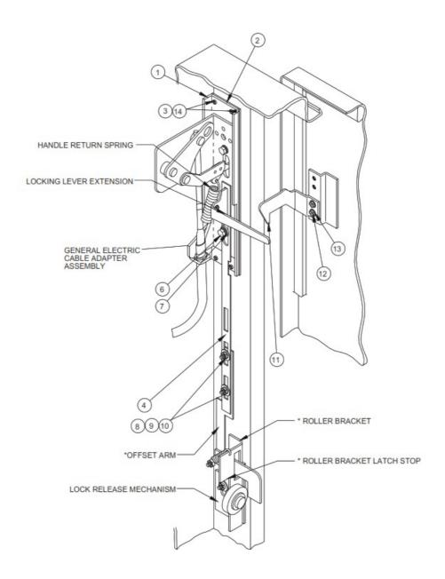
\* PARTS OF RELEASE MECHANISM ON ENCLOSURE WITH DISCONNECT ON RIGHT FLANGE
