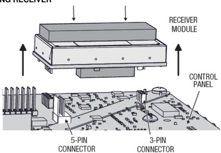
THE PLUG-IN RECEIVER MODULE IS LOCATED ON THE MAIN CIRCUIT BOARD, RIGHT BEHIND THE HOME BUTTON
