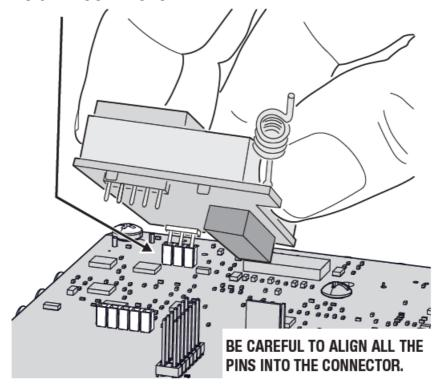
INSERT THE TRANSCEIVER PARTWAY INTO THE 3-PIN CONNECTOR
