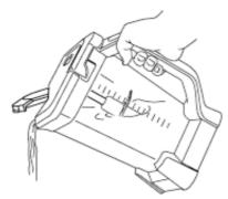
7. To pour out thinner mixtures, ensure the lid is locked in place, then open the pour spout cap.
