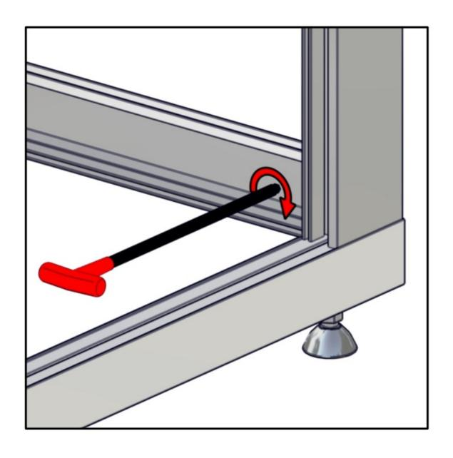
NOTE: BOTTOM CROSS BRACE SITS ON TOP INSIDE EDGE OF LEFT AND RIGHT SUPPORT LEG
