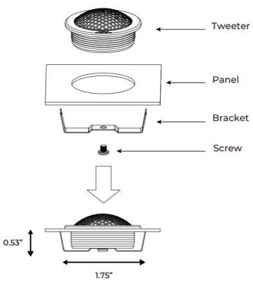
**Cut Out Diameter:** 1.75" **Mounting Depth:** 0.53
