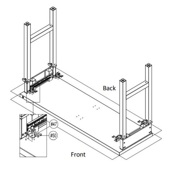
Step 5. Install (#3-B) BottomCrossbar /(#6-1) Leveling Feet
