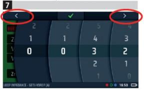
Set the maximum circuit current Stellen Sie den maximalen Kreisstrom ein Définir le courant de circuit maximal Establecer la corriente máxima del circuito
