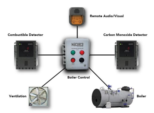
**EXAMPLE GAS BOILER CONTROLLER LAYOUT**
