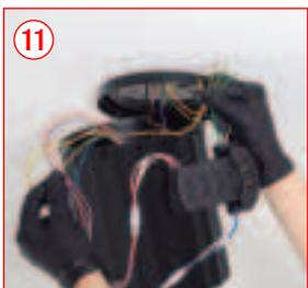
Conecte el cable FASE (L) del driver al cable FASE de su instalación.
