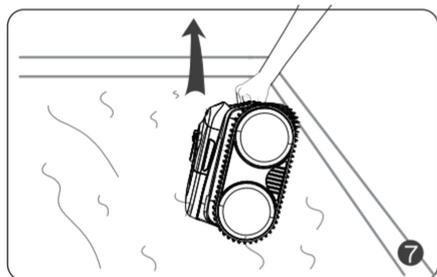
Debes sacar el limpiador verticalmente para drenar el agua del interior rápidamente.
