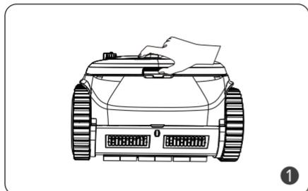
Sostenga el asa de la tapa del filtro, presione y levante la tapa
