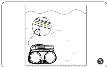
El dispositivo se moverá automáticamente para detenerse en el borde de la pared cuando termine de limpiar o cuando la batería esté baja.
