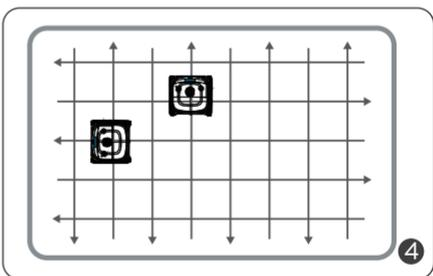
El limpiador comienza a limpiar las paredes, el suelo y la línea de flotación como predeterminado o su configuración a través de App.
