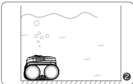
Deje que se hunda hasta el suelo para vaciar el aire atrapado en el interior.
