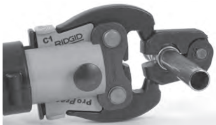
Abbildung 10 – Ansetzen der Ringbacke am Pressring
