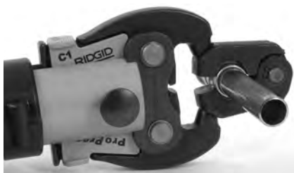
Figura 10 – Montaje del accionador en el aro sellador
