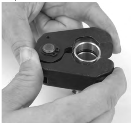
Figura 9 – Montaje del aro sellador en el acoplamiento
