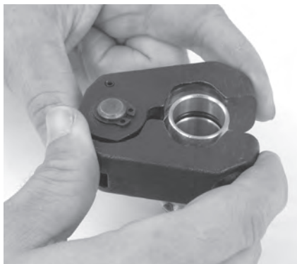
Abbildung 9 – Anbringen des Pressrings am Fitting
