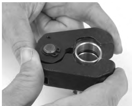
Figure 9 – Engagement de la bague de sertissage sur le raccord
