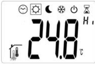
La valeur de la limite inférieure peut être calculée en fonction du point de consigne de la température si l'utilisateur utilise le paramètre 20 (voir Menu de paramètres). Lorsque ce mode est activé, la valeur de la limite inférieure est égale au point de consigne de la température moins la valeur définie avec le paramètre 25. Ce calcul ne dépend pas du système associé au thermostat (gamme r.f.u ou gamme r.f.b (Touch E3)).
