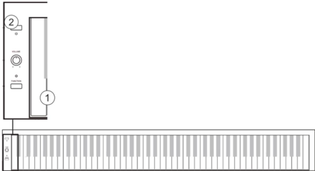
Um die automatische Abschaltung des Instruments zu deaktivieren, drücken und halten Sie bei ausgeschaltetem Instrument die äußerste linke Taste der Klaviatur und schalten Sie das Instrument mit der POWER-Taste ein.
