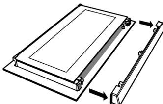
3. Heben Sie, wie in der Abbildung gezeigt, das innerste Glas (1) vorsichtig in Richtung „A“ an und entfernen Sie es dann, indem Sie es in Richtung „B“ ziehen.
