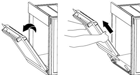
8. Ziehen Sie die entriegelte Tür nach oben, um sie aus dem rechten und linken Scharnier zu lösen und zu entfernen.
