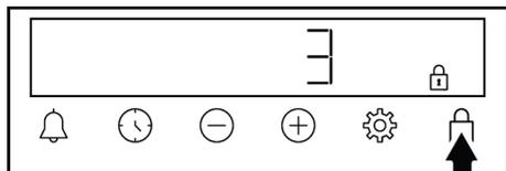
⇒ Das Symbol
