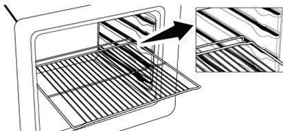
**Stopperfunktion für Backbleche - Bei Modellen mit Seitengittern**
