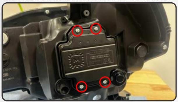
18. PULL THE DRIVER OFF OF THE HOUSING, DEPRESS THE CUP ON EACH OF THE DRIVER CONNECTORS AND PULL TO DISCONNECT THE DRIVER FROM THE INTERNAL HEADLIGHT WIRING
