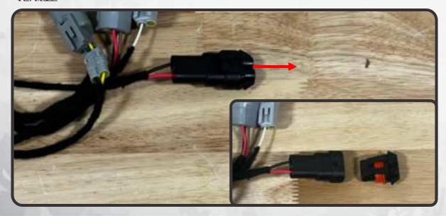
29. LIFT THE HEADLIGHT UP TO THE HEADLIGHT CAVITY, AND CONNECT THE DRL HARNESS AND HEADLIGHT ADAPTER HARNESS TO THE CONNECTORS ON THE BACK OF THE HEADLIGHT ASSEMBLY
