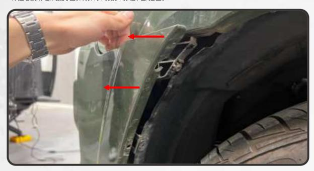
8. PULL THE SIDE OF THE BUMPER FORWARD, RELEASING IT FROM THE BUMPER COVER BRACKET ON THE BOTTOM OF THE HEADLIGHT ASSEMBLY. REMOVE THE 10MM BOLT ON THE FENDER BRACKET THAT WAS BEHIND THE SIDE OF THE BUMPER COVER
