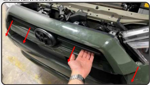
4. MOVING TO THE SIDE OF THE BLIMPER COVER IN FRONT OF THE WHEEL, REMOVE THE THREE 10MM SCREWS FROM THE SIDE OF THE BUMPER IN FRONT OF THE FRONT WHEEL.
