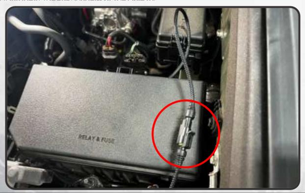
25. ROUTETHE SHORTER END OF THE DRUHARNESS FORWARD TO THE DRIVER-SIDE HEADLIGHT CAVITY
