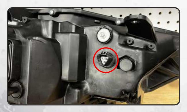
17. IF YOU HAVE PURCHASED THER MORIMOTO XB SUPERCHARGED HEADLIGHT DRIVERS (SOLD SEPARATELY, FOR OFFROADUSE ONLY), REMOVE THE FOUR PHILLIPS HEAD SCREWS SECURING THE STANDARD HEADLIGHT DRIVER TO THE BACK OF THE HEADLIGHT.
