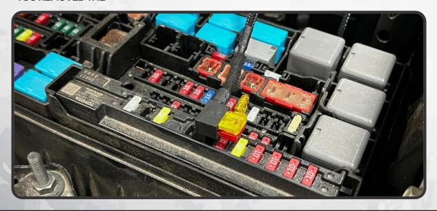
23. ROUTE THE FUSE TAP OUT OF THE FUSE BOX. USING A DRILL WITH A 5.5MM/7/32" DRILL BIT OR A SMALL CUTTING TOOL, MAKE A NOTCH IN THE SIDE WALL OF THE FUSE BOX LID FOR THE HARNESS TO PASS THROUGH, AND INSERT THE GROMMET ON THE FUSE TAP INTO THE NOTCH. CLOSE THE FUSE BOX LID DOWN OVER THE HARNESS
