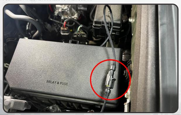
25. ROUTE THE SHORTER END OF THE DRL HARNESS FORWARD TO THE DRIVER-SIDE HEADLIGHT CAVITY
