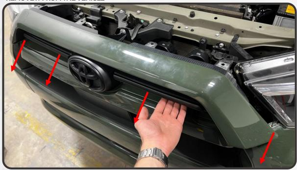
4. MOVING TO THE SIDE OF THE BUMPER COVER IN FRONT OF THE WHEEL, REMOVE THE THREE 10MM SCREWS FROM THE SIDE OF THE BUMPER IN FRONT OF THE FRONT WHEEL
