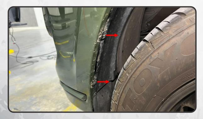
7. PULL THE TOP TAB OF THE BUMPER COVER BACK TOWARDS THE WHEEL, AND THEN PULL THE BUMPER COVER AWAY FROM THE FENDER
