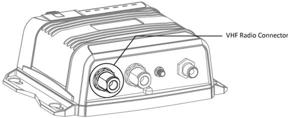
**Figure 5 VHF Antennenanschluss**
