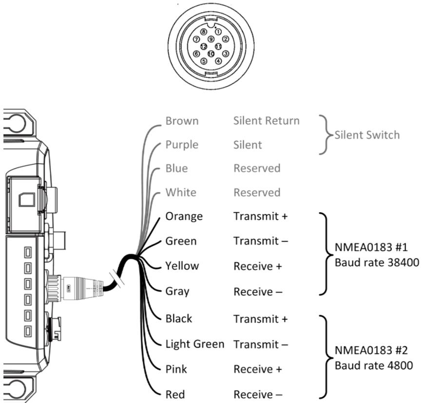
Figure 8 NMEA 0183 Verbindung
