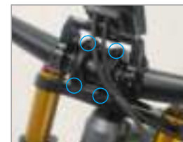
2. Installare il sollevatore maniglia
