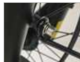
7. Installez la vis de support de garde-boue
