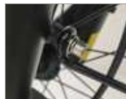
7. Installare le viti della staffa del parafrangente
