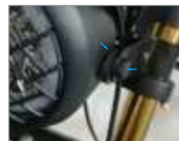
10. Wie in der Abbildung gezeigt, wurde die Dichtung installiert
