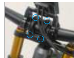
2. instale el tubo vertical de la manija
