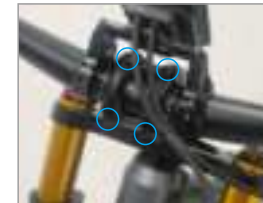
2. Installieren Sie den Griff Riser
