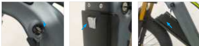
Abrir la cerradura de la batería
