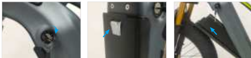
Apri il blocco della batteria
