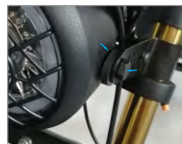
10. Come mostrato nella figura, la guarnizione è stata installata
