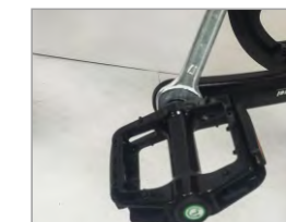
12. Estrarre i pedali con le lettere "R" e "L", allinearli con il foro della manovella e bloccarli con una chiave chiave
