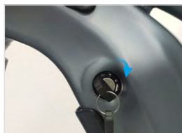
Ouvrir le verrouillage de la batterie
