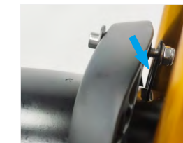
6. Installare il parafango come mostrato in figura
