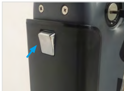
Premere l'interruttore per espellere la batteria
