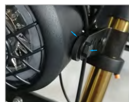
10. como se muestra en la imagen, la arandela está instalada
