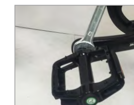
12. Retirez les pédales avec les lettres "R" et "L", Alignez-les avec le trou de manivelle et Verrouillez-les avec une clé
