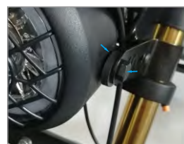
10. Comme le montre l'image, la rondelle est déjà installée
