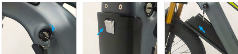
Abrir la cerradura de la batería
