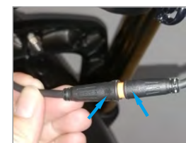
11. Schließen Sie das optische Kabel an (beachten Sie, dass die Richtung des Pfeils übereinstimmen muss)
