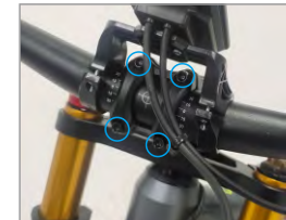
2. Installieren Sie den Griff Riser
