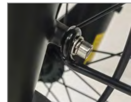
7. Installieren Sie die Schrauben der Schutzblechhalterung
