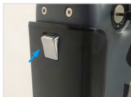
Appuyez sur l'interrupteur pour éjecter la batterie
