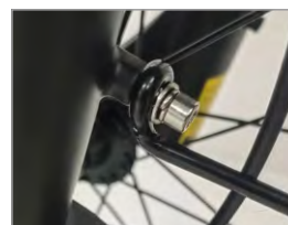
7. Installez la vis de support de garde-boue
