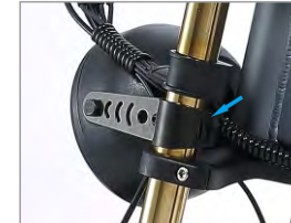
8. Installieren Sie die Lampe
