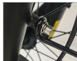
7. Installare le viti della staffa del parafango
