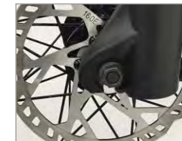
5. Ziehen Sie die linke und rechte Mutter, wie in der Abbildung gezeigt
