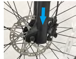
4. Installieren Sie die vordere Gabel auf das vordere Radlager
