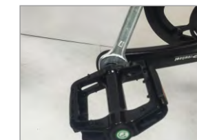
12. Nimm die Pedale mit den Buchstaben "R" und "L" heraus, richte sie mit dem Kurbelloch aus und verriegele sie mit einem Schraubenschlüssel
