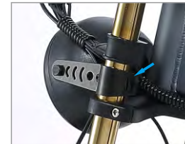
8. Installare la lampada
