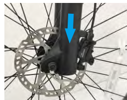
4. Installare la forcella anteriore sul cuscinetto della ruota anteriore
