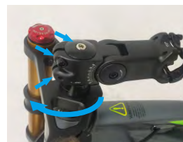
1. Ajustez les vis supérieure et gauche et droite pour faire pivoter la colonne montante réglable de 180 degrés et la maintenir en place
