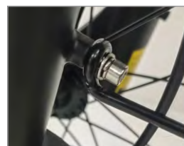
7. instale los tornillos de soporte del guardabarros
