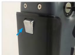
Drücken Sie den Schalter, um die Batterie auszuwerfen
