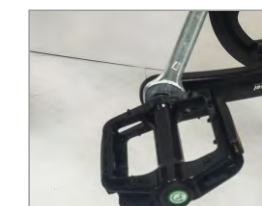
12. retire el pedal con las letras "r" y "l", alinéelo con el agujero de la manivela y bloquee con una llave inglesa
