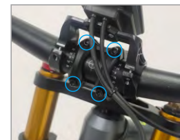
2. instale el tubo vertical de la manija
