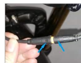
11. Connectez le câble optique (Notez que la direction de la flèche doit correspondre)
