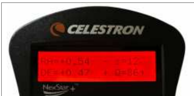
Abb. 12: Beim Autoguiding mit der NexStar+ Handsteuerung sehen Sie den Führungsfehler für beide Achsen auf dem LCD.
