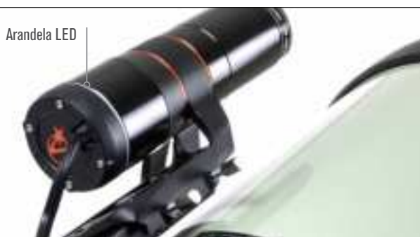
Fig. 23: La arandela LED indica el estado de SSAG de un vistazo.
