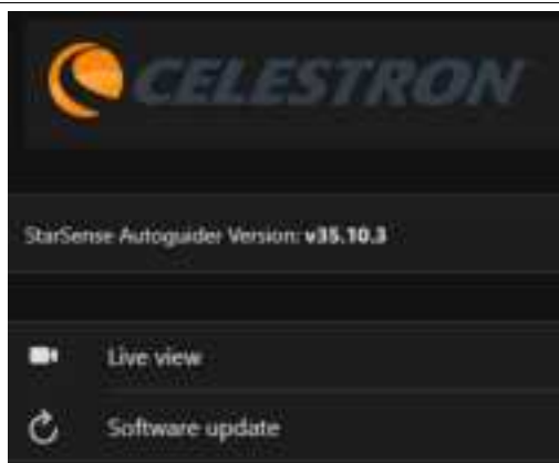
Fig. 25: In alternativa, è possibile aggiornare il firmware di SSAG attraverso l'interfaccia web. Da qui sarà possibile anche avere accesso alla visualizzazione dal vivo.
