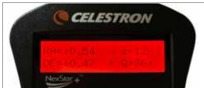
Fig. 12: Durante l'autoguida con la pulsantiera NexStar+, si vedrà l'errore di guida per entrambi gli assi sul display LCD.
