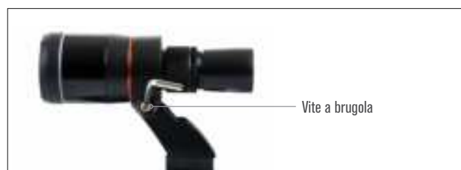
Fig. 8: Installare il SSAG nella staffa piccola come mostrato, quindi riserrare la vite a brugola sulla staffa.
