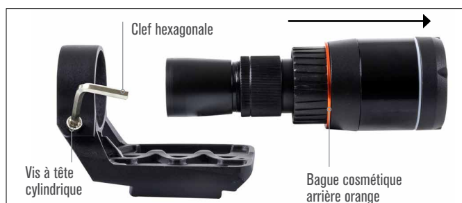
Fig. 7: Desserrez la vis à six pans creuse. Retirez le SSAG du grand support, y compris l'anneau orange arrière.
