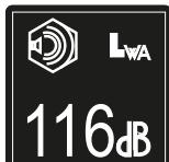
(DE) (AT) (CH) Angabe des garantierten Schallleistungspegels  $L_{WA}$  in dB.
