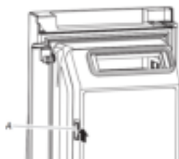
A. Loquet de porte du compartiment à glaçons
