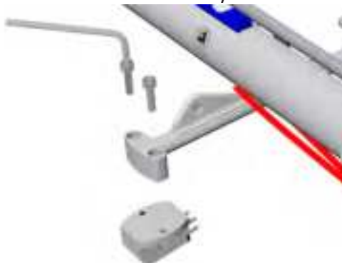
Abb. 9: Montage des Tonabnehmers
