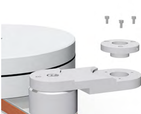
Abb. 5: Montage der Klemmbasis
