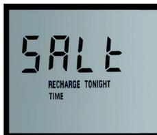
En pressant une fois la touche [SET] (entrée), l'heure de régénération est validée et l'affichage passe au mode de réglage du type de sel utilisé.
