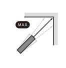
按 选择面积测量模式 二 ,根据闪烁边提 示,按测量键 ,测得第一条边距离(长), 再次按测量键 ,测得第二条边距离(宽), 面积计算结果显示在主显示行。
