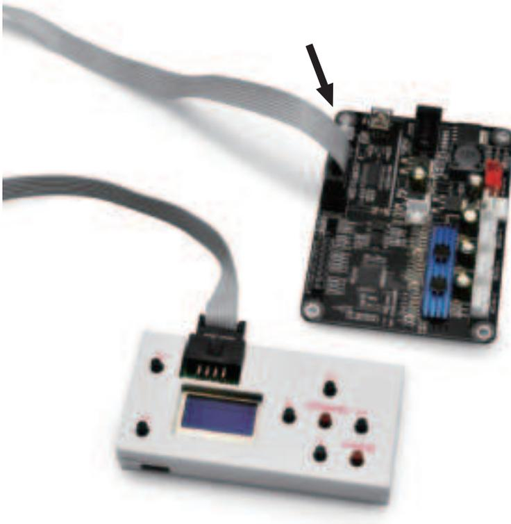
4. Drücken Sie anschließend die Tasten [X+/X-/Y+/Y-/Z+/Z-], um die Spindel auf die „0“-Stellung zu verfahren. Wählen Sie die CNC-Datei aus. Klicken Sie nochmals auf die Taste [OK], um den Fräs-/Gravurvorgang zu starten.
