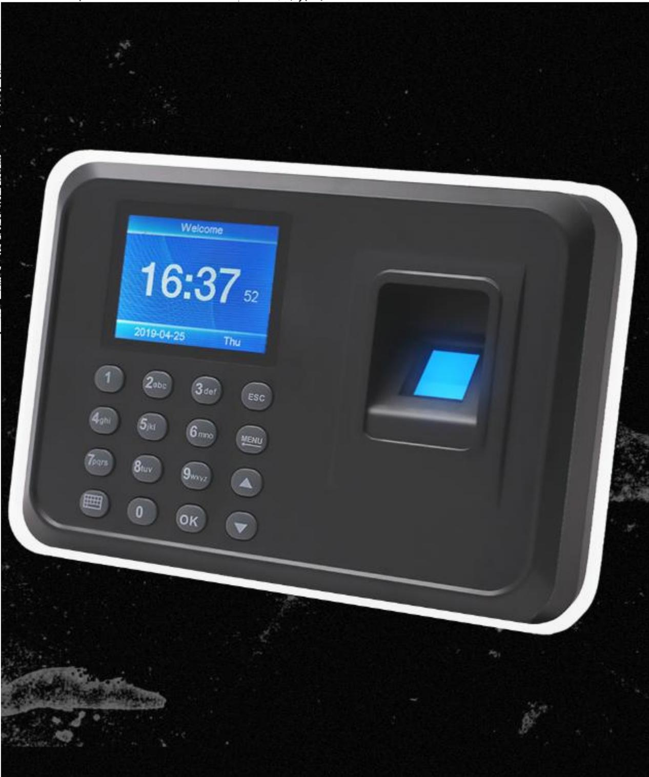
**Der Recorder FTR01 ist ein einfach zu bedienendes Gerät zur Arbeitszeiterfassung, zum Offline-Betrieb und ohne zusätzliche Software. Es ermöglicht eine präzise Mitarbeiteranmeldung per Passwort oder Fingerabdruck und zeichnet bis zu 100.000 Ereignisse auf. Mit einer einfachen Installation, einem großen Display und der Möglichkeit, Daten über USB zu exportieren, ist es ideal für jedes Unternehmen.**
