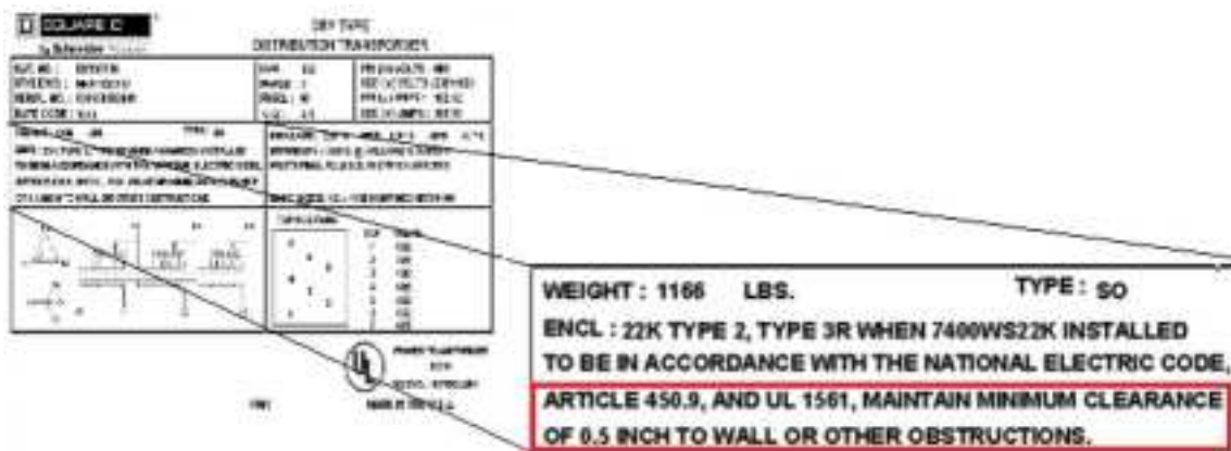
Figura 14 - Distancia mínima marcada en la placa de datos NEC 450.9
