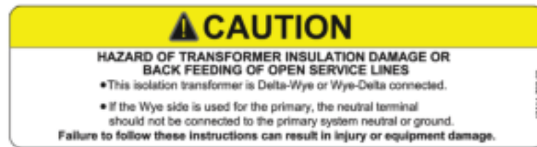
Figura 32 - Etiqueta de precaución para transformadores conectados Delta-Estrella o Estrella-Delta
