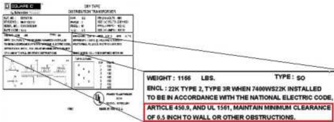
Figure 14 - Distance minimale indiquée sur la plaque signalétique NEC 450.9
