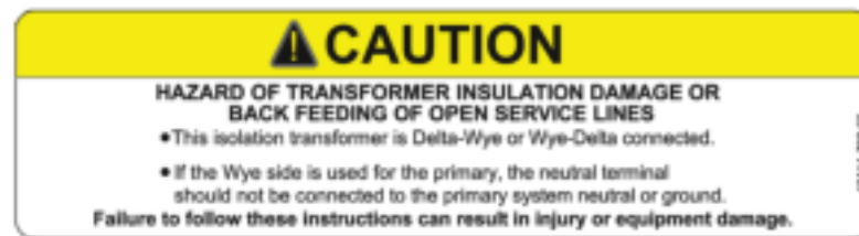
Figure 32 - Étiquette de précaution pour les transformateurs raccordés en étoile
