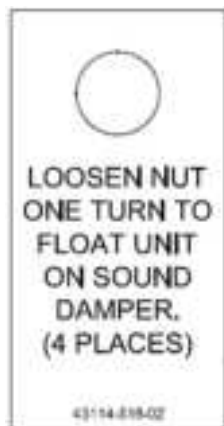
Figura 25 - Etiqueta de Aflojar la tuerca una vuelta completa (cuatro posiciones)
